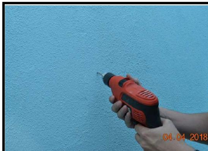
Uso de furadeira para identificar a ausência de pilares
