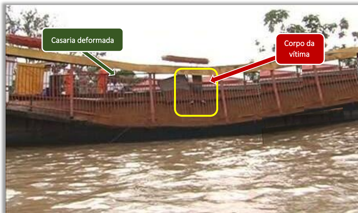
Figura 2 – Balsa acidentada. Área de segurança deformada, atingida pelo colapso do talude
