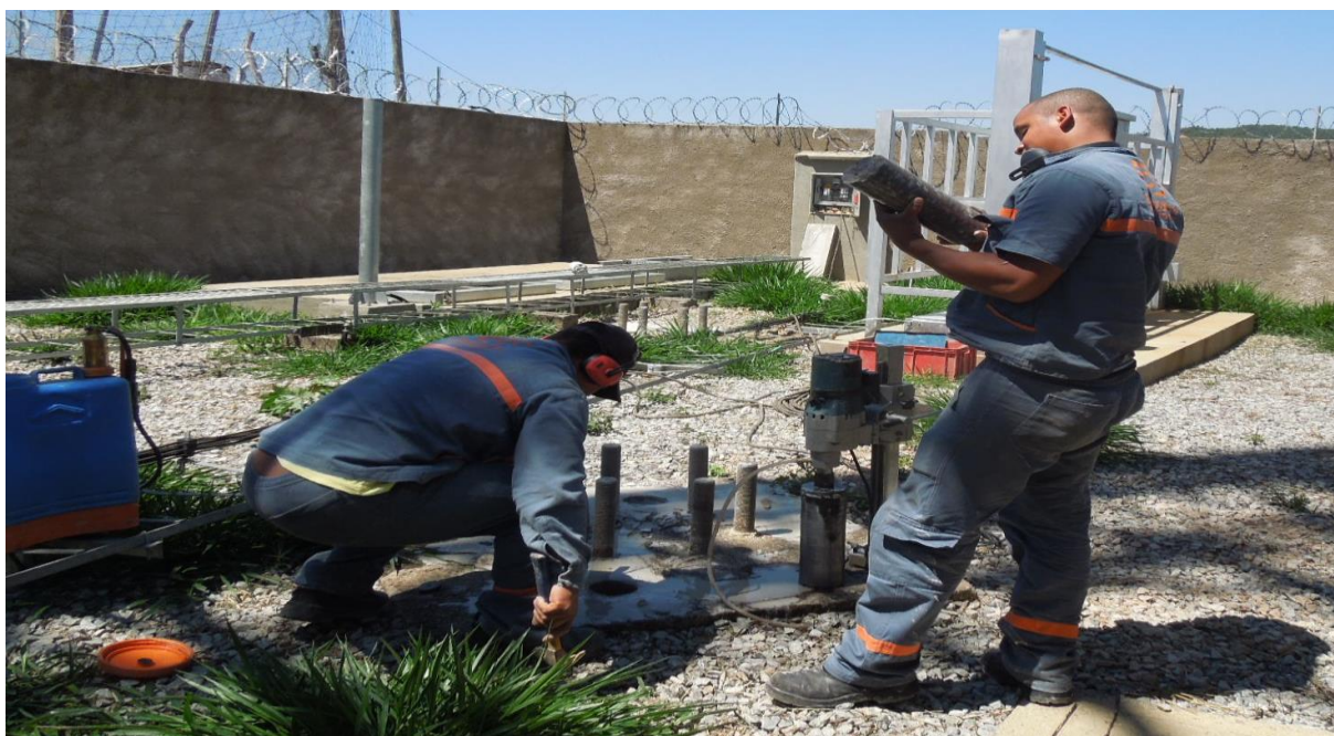
Imagem 07 – Preparação e extração de testemunho do Bloco 03. Fonte: Autores
