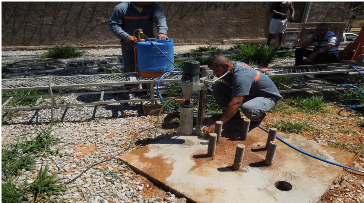
Imagem 06 – Preparação e extração de testemunho do Bloco 02. Fonte: Autores
