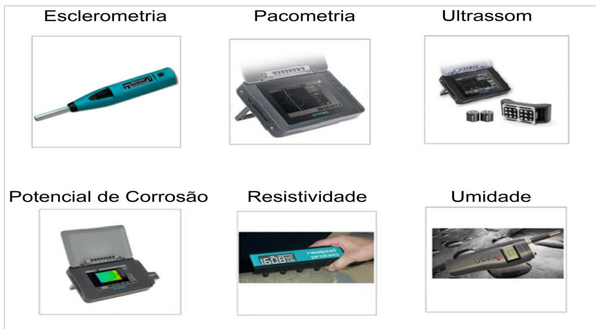
Figura 08 – Alguns dos principais equipamentos utilizados para a realização de ensaios não destrutivos.
