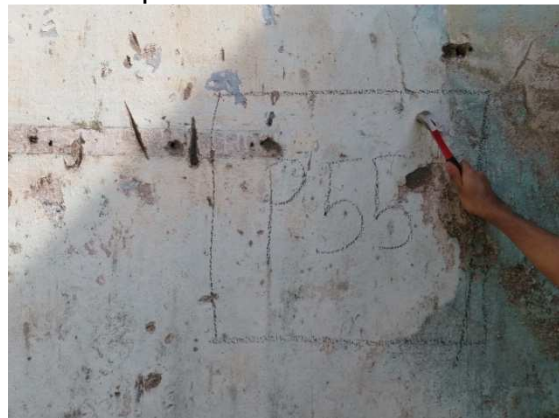
Figura 79 - SALA 2/ FUNDOS. Interno. Teste de percussão em reboco
