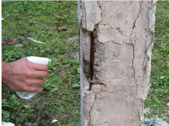
Figura 76 - SALA 2/ FUNDOS. Interno. Verificação do pH do concreto, indicando leitura inferior a 9 (ausência de coloração
