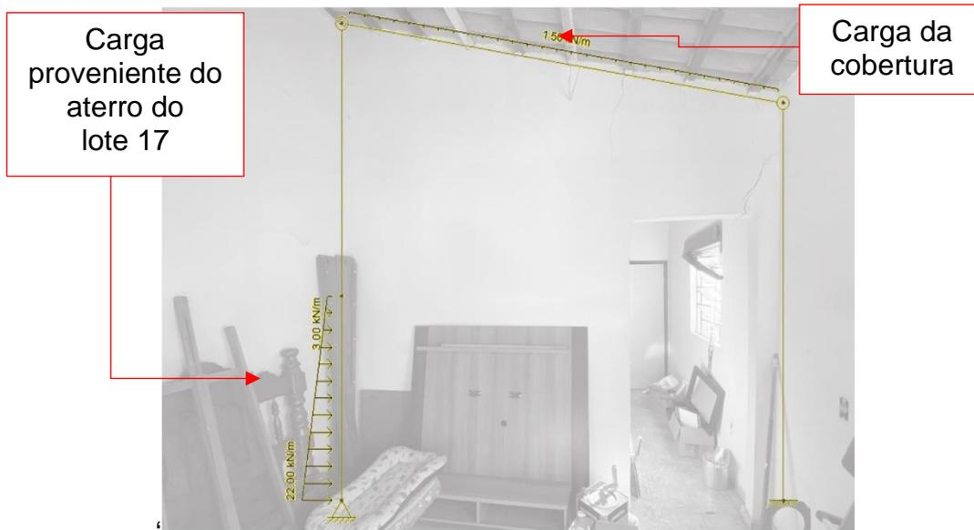
**Figura 12** – A imagem acima ilustra a condição esboçada na “Figura 10” acrescida do carregamento do aterro executado no lote 17. Fonte: Autor.
