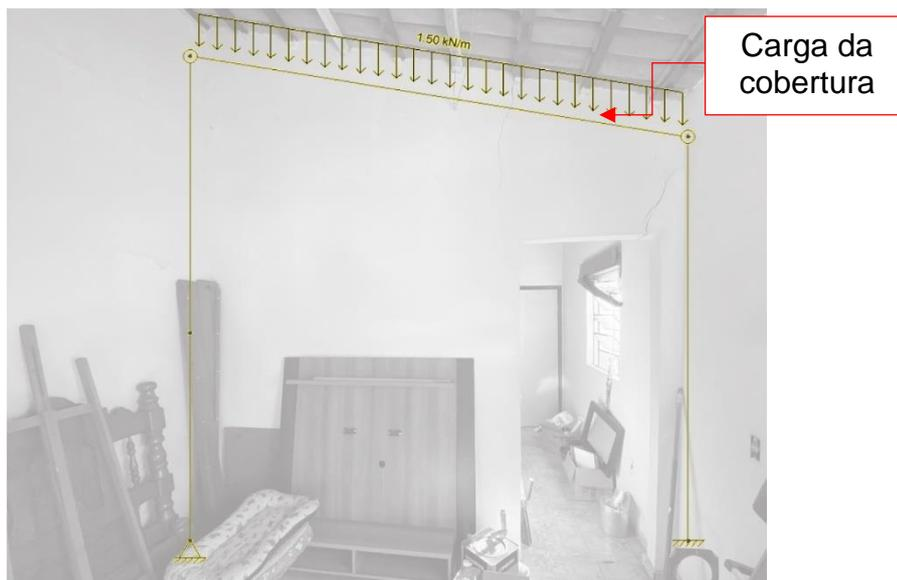
**Figura 10** – A imagem acima ilustra somente o carregamento da cobertura simplesmente apoiada nas alvenarias. Fonte: Autor.
