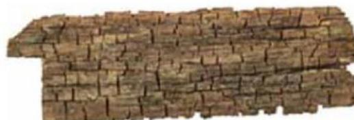
Figura 8 - Características visuais de madeiras infectadas com fungos de podridão parda em estágio avançado de biodeterioração. Fonte: Brito, 2014.
