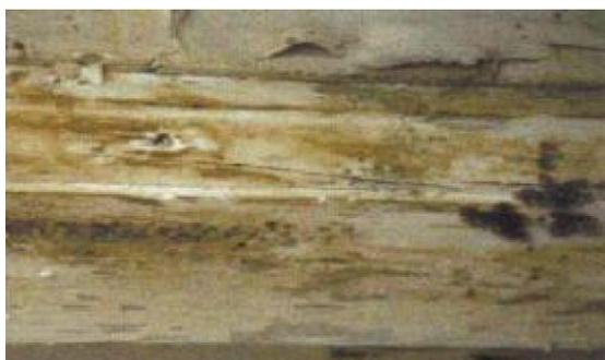
Figura 7 - Características visuais de madeira atacada por fungos emboloradores. Fonte: Brito, 2014.
