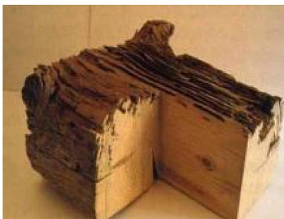
Figura 9 - Características visuais de diagnóstico de deteriorações em madeira resultantes de ataque por térmitas, ataque externo. Fonte: Brito, 2014.
