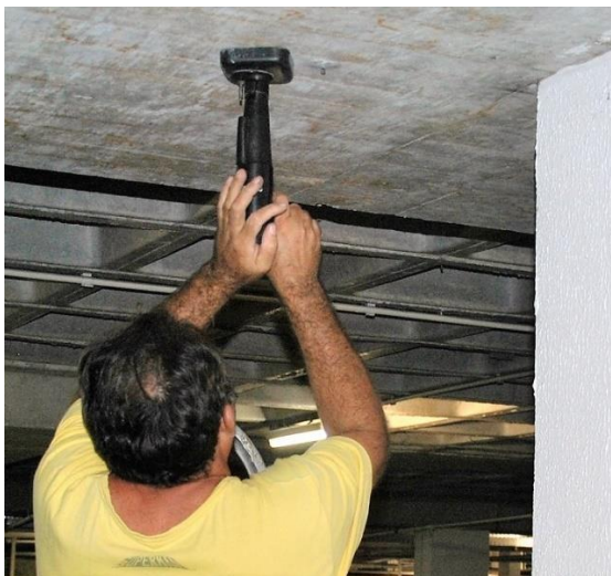
Método da cravação com medição da parte aparente do pino após o impacto.
