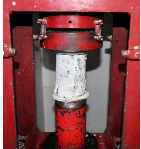
a) Extração de testemunhos com ruptura em laboratório.
