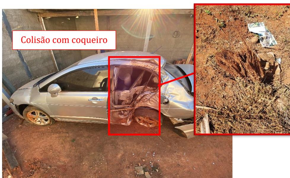
**Figura 29** – Vista lateral esquerda do veículo – avaria de colisão com coqueiro.
