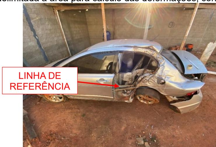
**Figura 32** – Análise das deformações conforme método de *Campbell*.
