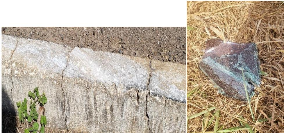
**Figura 26** – Identificação de ranhuras no meio fio e estilhaços de vidro do veículo.
