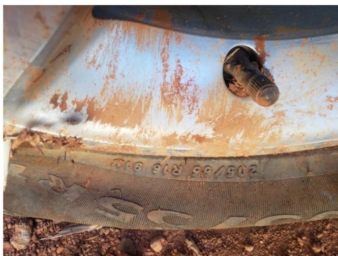
**Figura 30** – Vista roda do veículo com evidências de contato com coqueiro e terra.
