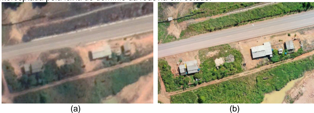
Figura 20 – (a) Imagem orbital do Google Earth. (b) Ortomagem resultante do processamento aerofotogramétrico com GSD de 2,8cm. Fonte: Autores (2021).
