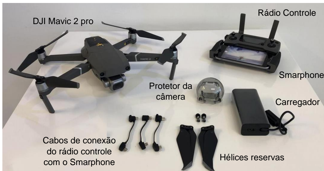
Figura 8: Vista da ARP (drone aéreo) modelo DJI Mavic II PRO e acessórios, referente ao mesmo utilizado nos levantamentos aéreos do presente estudo.
