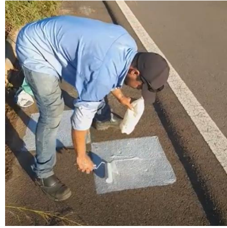
Figura 11 – (a) Vista do ponto de apoio tipo placa metálica, (b) Vista do ponto de apoio tipo pintura com tinta branca, (c) Vista do ponto de apoio do tipo implantação com cal, (d) Vista do rastreamento GNSS e pintura do ponto de apoio. Fonte: Autores (2021).
