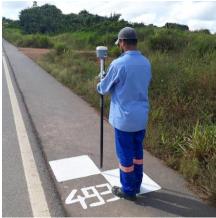
Figura 11 – (a) Vista do ponto de apoio tipo placa metálica, (b) Vista do ponto de apoio tipo pintura com tinta branca, (c) Vista do ponto de apoio do tipo implantação com cal, (d) Vista do rastreamento GNSS e pintura do ponto de apoio. Fonte: Autores (2021).
