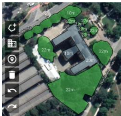
Figura 10 – Elaboração do modelo tridimensional do edifício e vizinhança. Fonte: App Drone Harmony.
